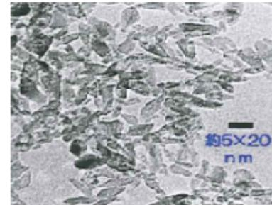
HybridCleanの酸化チタンは液状であり、一般的な酸化チタンの結晶に比べ、透明で長方形に近い経常の結晶(一次粒子)である。
